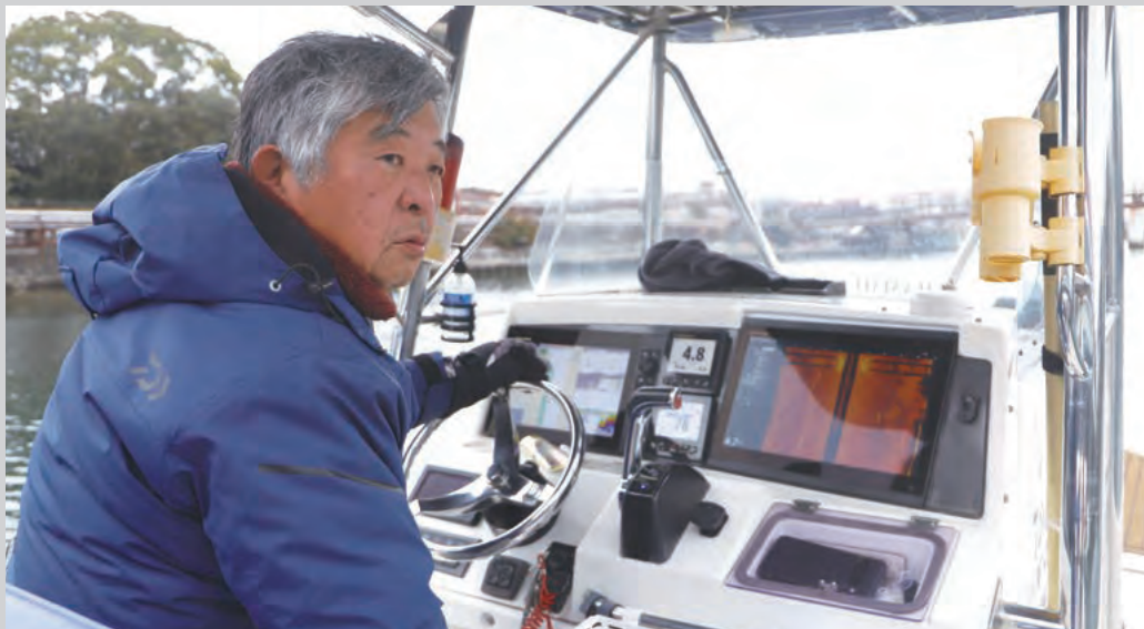
センターコンソールに TZT16X (TZTXL: 右側) と TZT12F (TZT3: 左側) を装備
