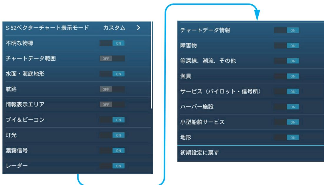
[S-52 ベクターチャート表示モード]: チャートに表示する情報のレベルを設定します。
