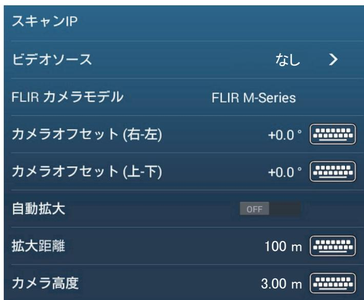
注) 本機から FLIR 社製 カメラの PTZ 機能を使用するには、FLIR カメラ側で追加の設定 (Nexus CGI Interface, port:8090) が必要です。詳細は、FLIR カメラの取扱説明書を参照してください。
