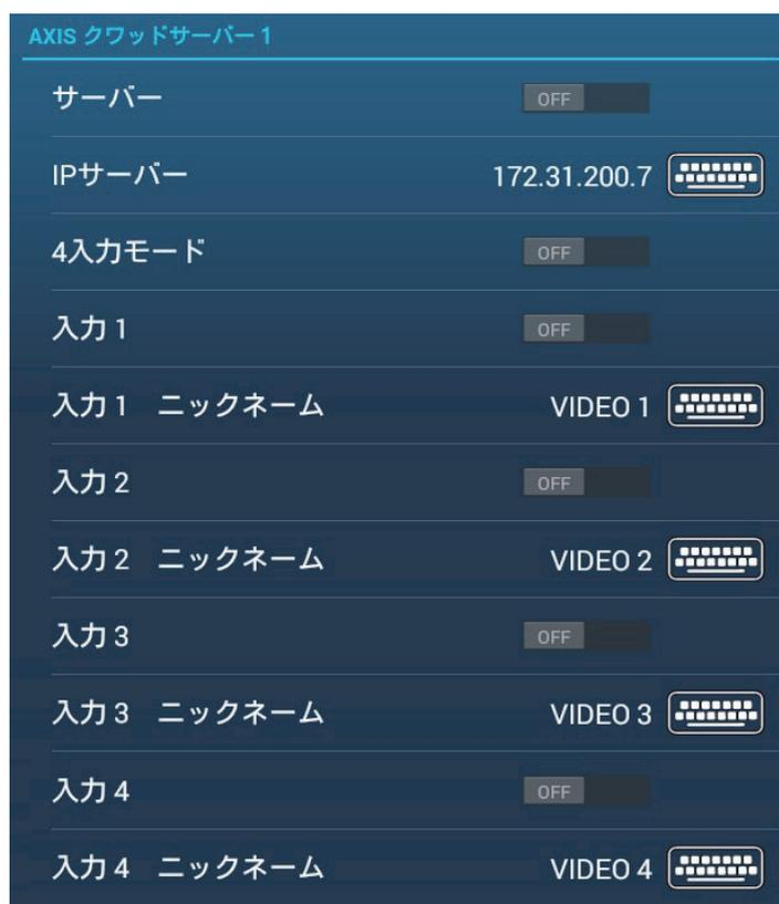
[サーバー] : AXIS クラウドサーバーからの信号を受信するときは、[ON] に設定します。
