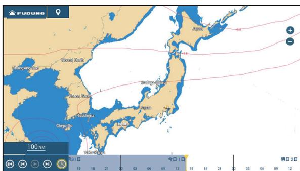
**海面温度データ**：海面温度を色のグラデーションで表示します。温度が低いほど濃青、高いほど赤で表示されます。画面上で[A]（自動）をタップするごとに、海面温度カースケールを自動設定にするか、しないかを設定することができます。手動モード（右図参照）時は、最小値または最大値を設定できます。設定方法については、3.2.1項を参照してください。
