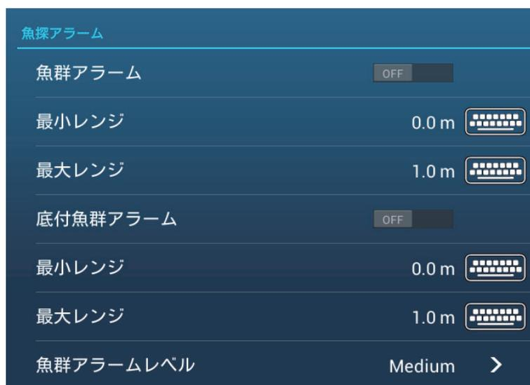
3. [最小レンジ]にはアラーム範囲の開始深度、[最大レンジ]には終了深度を設定し、[✓]をタップします。
