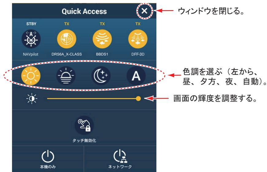
電源スイッチをタッチ（TZT9F/12F の場合は押下）するか、スライドバー上でアイコン（丸）をドラッグする（スライドバー上のタップでも調整可能）ことで、画面の輝度を調整することができます。
