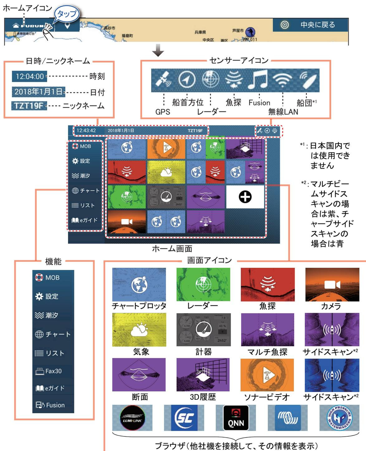
**日時/ニックネーム**：現在の日時と、本機のニックネームが表示されます。ニックネームは変更することができます。ニックネームをタップしてソフトウェアキーボードを表示し、ニックネームを設定します（1.15 節参照）。
