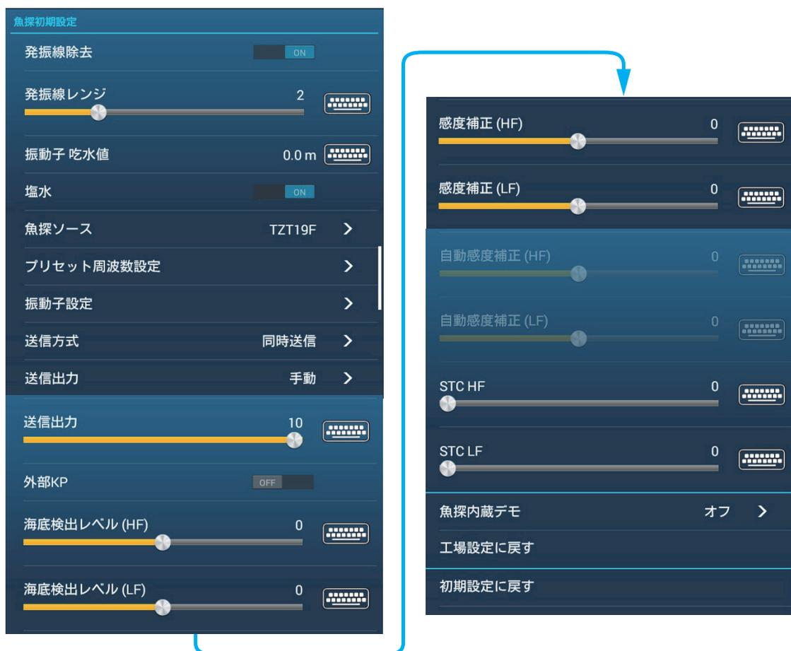
[発振線除去]: [ON] に設定すると、発振線除去機能が働いて表層近くの魚群反応を識別することができます。送受波器の種類や取付け状況によって、発振線の尾引きの長さが異なります。発振線が 1.4m 以上ある送受波器を使用している場合は、[ON] に設定してください。
