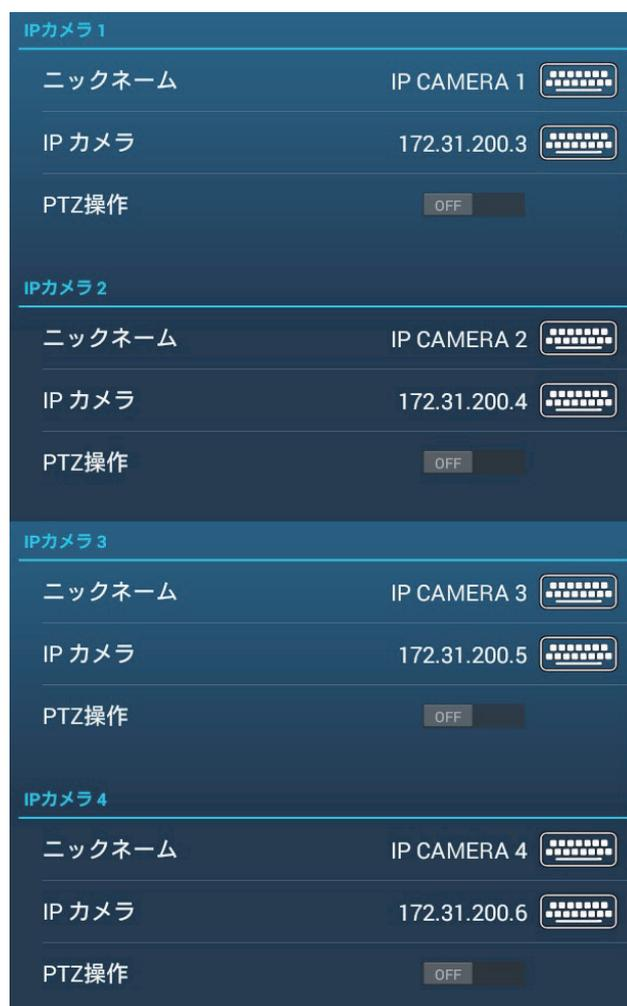
[ニックネーム]: 工場出荷状態では、[IP CAMERA 1]、[IP CAMERA 2]、[IP CAMERA 3]、または [IP CAMERA 4] に設定されています。このニックネームを判りやすい名前に変更することができます（最大 20 文字）。変更する場合は、[ニックネーム] をタップしてソフトウェアキーボードを表示します。名前の変更後、[✓] をタップします。変更した名前は、以下のところに反映されます。
