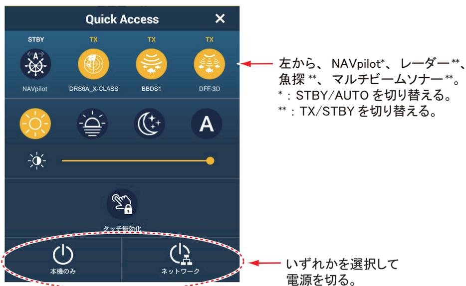
本機の電源のみを切る場合は、[ 本機のみ ] をタップします。ネットワークでつながっている NavNet TZtouch シリーズの電源も同時に切る場合は、[ ネットワーク ] をタップします。画面が暗くなり、「電源オフしています」というメッセージが表示され、数秒後に本機の電源が切れます。
