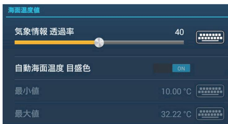
[ 気象情報 透過率 ] : [ 海面温度 ]、[ 波 ]、[ 雲 ]、[ 雨 / 雪 ]、[ 気温 ]、[ 海面高度 ]、および [ プランクトン ] の情報をダウンロードすると、画面上の海面が温度に応じて色で表示されます。その色表示の透過率を設定します。
