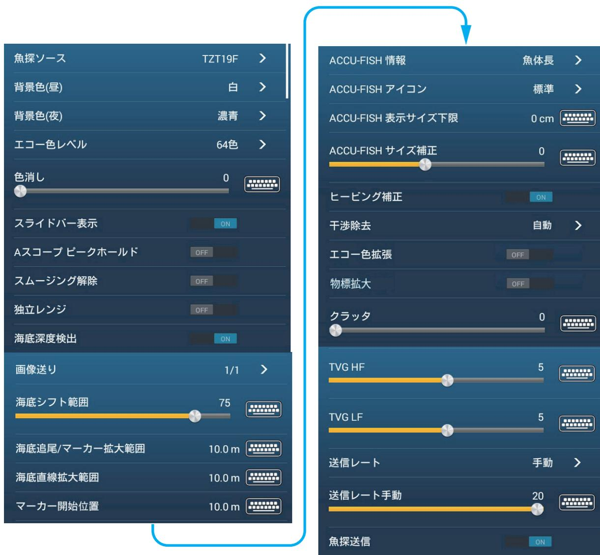
[魚探ソース]: 使用する魚探を設定します。ネットワーク魚探機器 (BBDS1、DFF1、DFF3、DFF1-UHD、DFF3-UHD)、および本機や同一ネットワーク内の NavNet TZtouch シリーズの内蔵魚探から選びます。後述の [魚探初期設定] 関連内にも [魚探ソース] の項目があり、使用する魚探を切り替えることができます。
