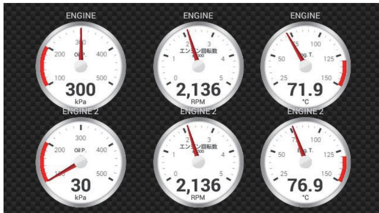
[エンジン数]メニュー（16.3 節参照）で設定したエンジンの数（工場出荷値：2）の画面が表示されます。3 分割 /4 分割画面では Single Engine、Twin Engines、Triple Engines が表示できます。
